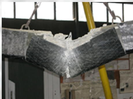
Badania nad wzmocnionymi elementami żelbetowymi
