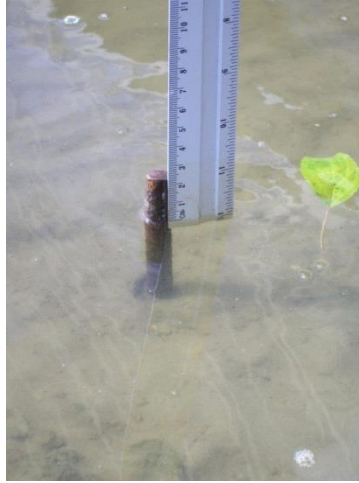
Rys. 2. Pomiar odległości od lustra wody do szczytu pręta (opracowanie własne).
