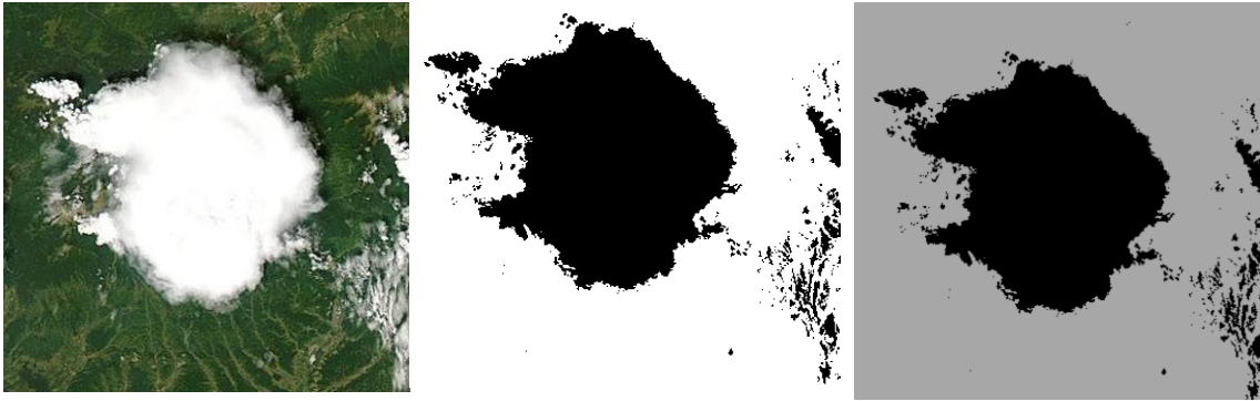
Rys. 10. Obraz oryginalny, obraz poddany binaryzacji i obraz wygładzony filtrem Gaussa z parametrem \sigma = 0.5 .
