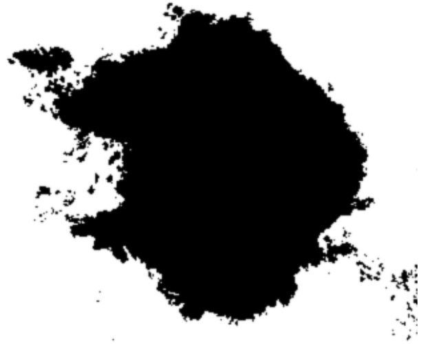
Rys.2. Obraz wejściowy po binaryzacji i zastosowaniu filtru Gaussa dla \sigma=0.5 oraz h=5 .
